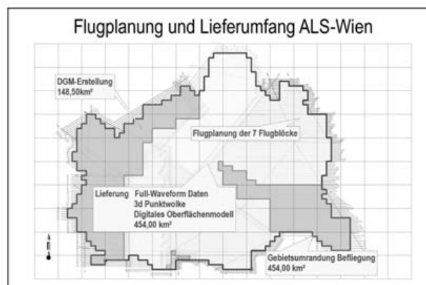
Flugplanung mit sieben Flugblöcken und Flächen der Beauftragung (FWF Daten, DGM und DOM) (© Elisabeth Wolf – Stadtvermessung Wien)
