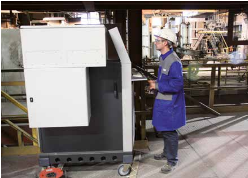
Messung von Schlacken im Stahlwerk der voestalpine Stahl GmbH mit einem LIBS-Gerät der Johannes Kepler Universität Linz
