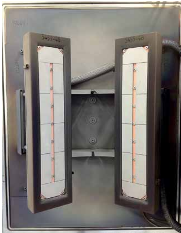
Zwei der im Projekt HIPERCUT entwickelten Titan-Aluminium-Zirkon-Rechtecktargets
