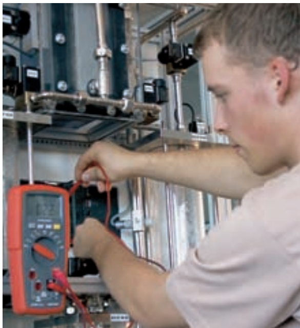
Der angehende Elektroniker Marcel Mehnert bei der Signalverfolgung mit einem Digitalmultimeter.
