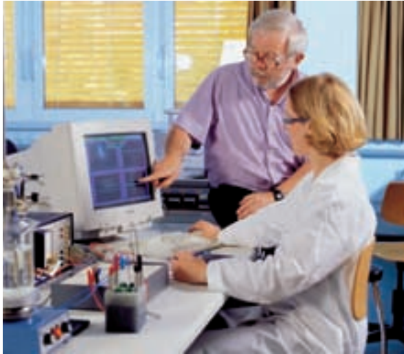
Die angehende Physiklaborantin Claudia Naegele mit dem Ausbilder Jochen Leonhardt bei einer PC-gestützten Temperaturmessung mit dem Messwerterfassungssystem COBRA.
