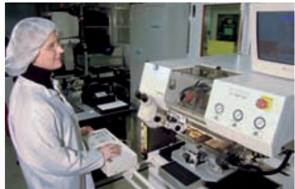
Arbeitsplatz einer Mikrotechnologin: Einrichten und Überwachen einer vollautomatischen Bondmaschine
