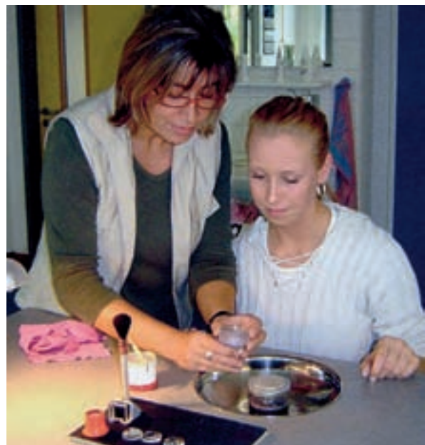
Auszubildende Stefanie Brosinger prüft mit Ausbilderin Cornelia Wüstefeld den Radius der hergestellten Linse mit einem Probeglas.
