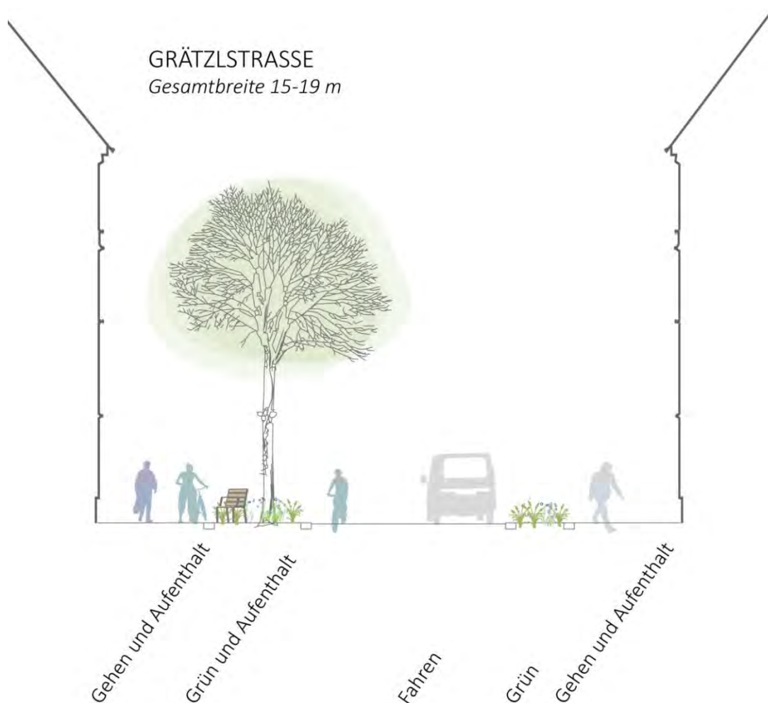
Abbildung 35: Der Straßentyp Grätzlstraße eignet sich für schmale Nebenstraßen mit gemischter Nutzung und ist wichtig für die kleinräumige Erschließung.
