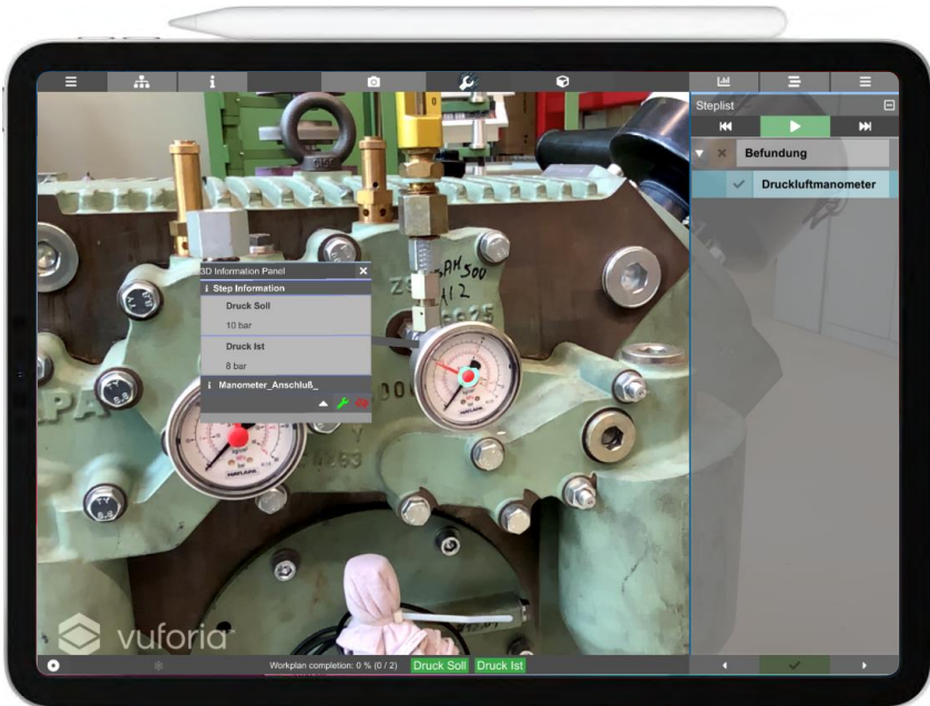
Abbildung 9: Selektieren von Bauteilen und Symptomanzeige im Schulungsbetrieb
