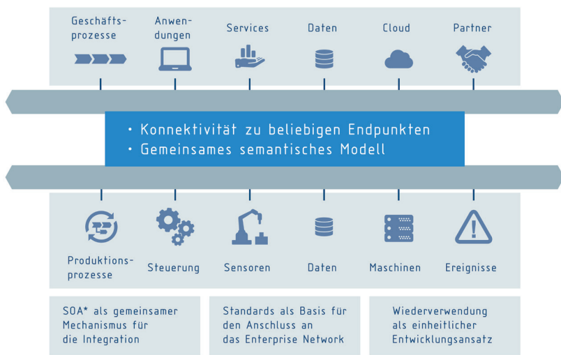
Abbildung 3: Herstellung der Konnektivität durch das Prinzip der serviceorientierten Architektur (Zentrale Verbindung zwischen Office Floor und Shop Floor – ZVEL, 2014) 89
